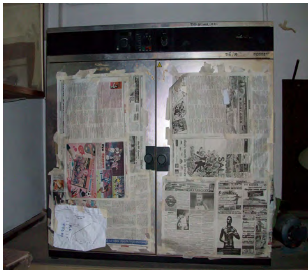
ภาพที่ 5 เตาอบไว้สำหรับอบตัวอย่างตะกอนที่เปียกก่อนที่จะนำไปทำการคัดขนาด
