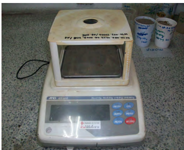
ภาพที่ 6 เครื่องชั่งแบบละเอียด ไว้สำหรับชั่งตัวอย่างตะกอนทั้งก่อนคัดขนาดและหลังคัดขนาด
