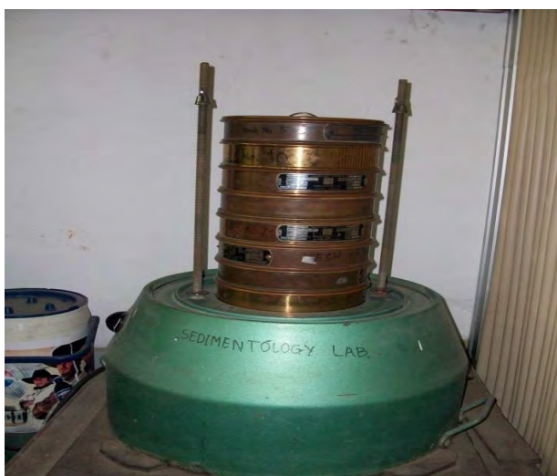
ภาพที่ 7 เครื่องคัดขนาดตะกอน (sieve analysis) ทำการแยกขนาดตะกอนตัวอย่างผ่านตะแกรงคัดขนาด ซึ่งเรียงจากขนาดช่องใหญ่ไปช่องละเอียด ได้แก่ #5,#10,#18,#35,#60,#120,#230,pan
