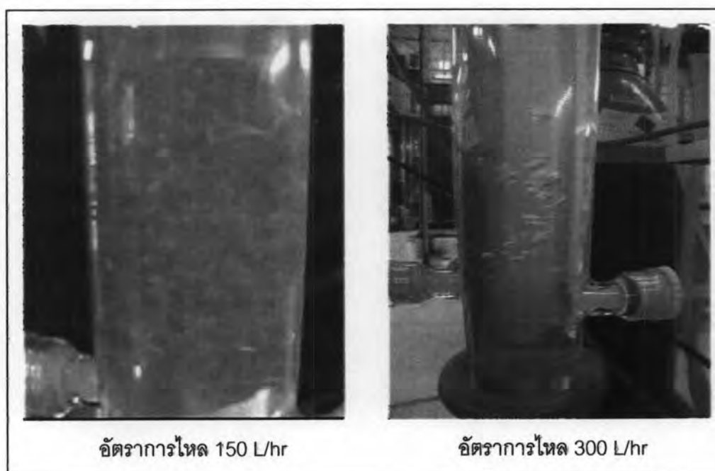
รูปที่ 4.30 แสดงลักษณะการรวมตัวของฟองอากาศเมื่ออัตราการไหลสูงขึ้น
