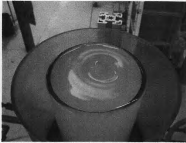
รูปที่ 4.32 จุดศูนย์กลางการหมุนที่เกิดขึ้นเมื่อเพิ่มอัตราการไหลสูงขึ้น
