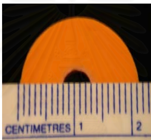
รูปที่ 24 แสดงแบบทรงกระบอกซิลิโคนที่มีเส้นผ่าศูนย์กลางด้านใน 5 มิลลิเมตร และสูง 4 มิลลิเมตร
