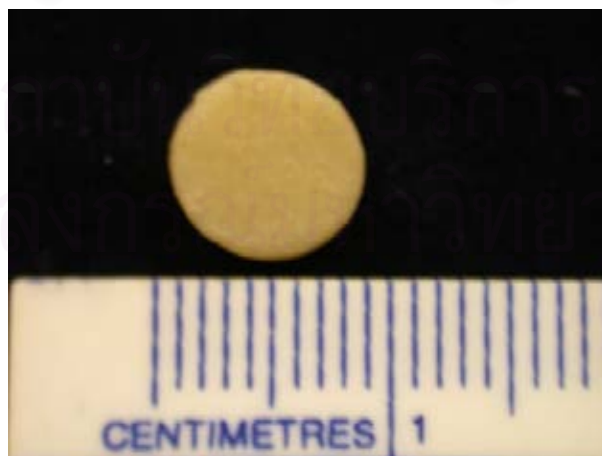
รูปที่ 10 แสดงแบบขึ้นงานตัวอย่างรูปร่างดิสก์ ขนาดเส้นผ่าศูนย์กลาง 9 มิลลิเมตร หนา 2 มิลลิเมตร
