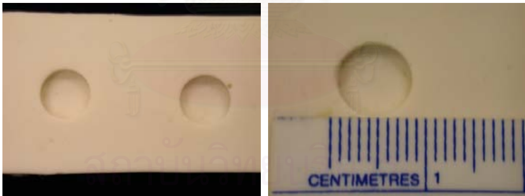
รูปที่ 5 แสดงดิสก์โลหะทองเหลือง ขนาดเส้นผ่าศูนย์กลาง 9 มิลลิเมตร หน้า 2 มิลลิเมตร
