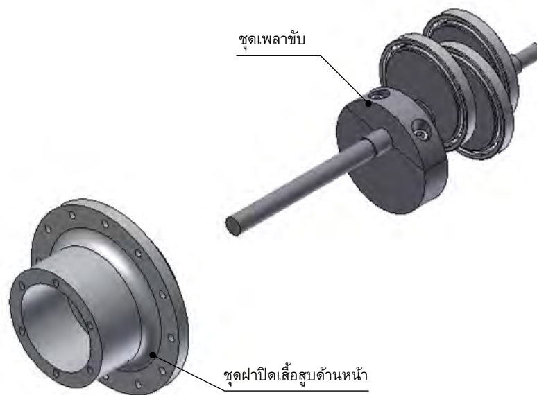
รูปที่ ๑-12 การประกอบชุดฝาปิดเสื้อสูบด้านหน้าเข้ากับชุดเพลาลูกสูบ
