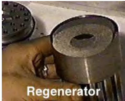
รูปที่ 4-13 รีเจนเนอเรเตอร์ของเครื่องยนต์สเตอร์ลิง Ecoboy-SCM81
