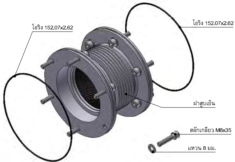
รูปที่ ฉ-23 การประกอบสลักเกลียวเข้ากับฝาสูบเย็น
