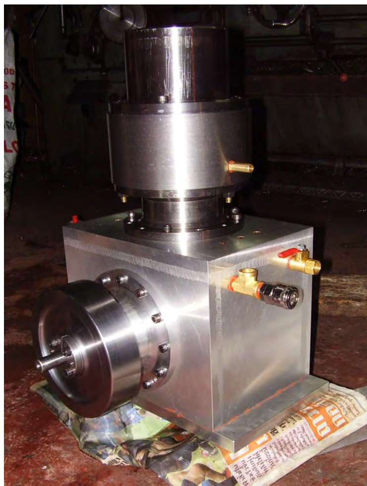
รูปที่ 4-3 เครื่องยนต์สเตอร์ลิงต้นแบบที่ผลิตด้วยแนวคิดก่อนหน้า
