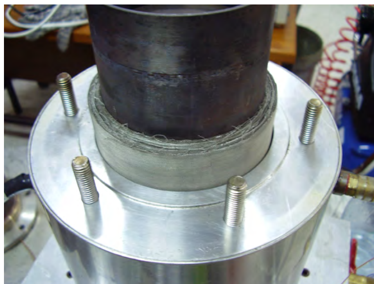
รูปที่ 4-14 การประกอบรีเจนเนอเรเตอร์เข้ากับเครื่องยนต์สเตอร์ลิง
