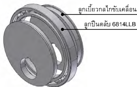
รูปที่ จ-1 การประกอบลูกปืนเข้ากับลูกเบี้ยวของกลไกขับเคลื่อน
