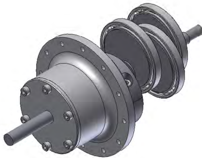
รูปที่ ฉ-14 ชุดเพลลาขับที่ประกอบเข้ากับชุดฝาปิดเสื่อสูบด้านหน้า
