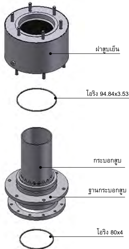
รูปที่ ฉ-25 แสดงขั้นตอนการประกอบฝาสูบเย็นเข้ากับฐานกระบอกสูบ
