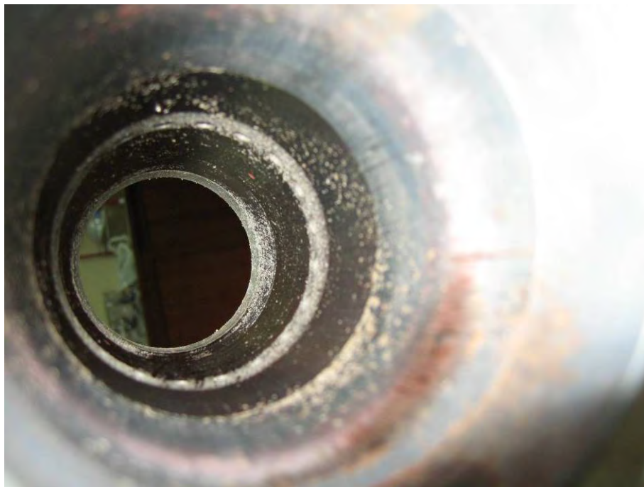
รูปที่ 5-19 ผงเทพลอนที่เกิดจากการสึกหรอของแหวนลูกสูบกำลังกระจายติดตามผนังกระบอกสูบ
