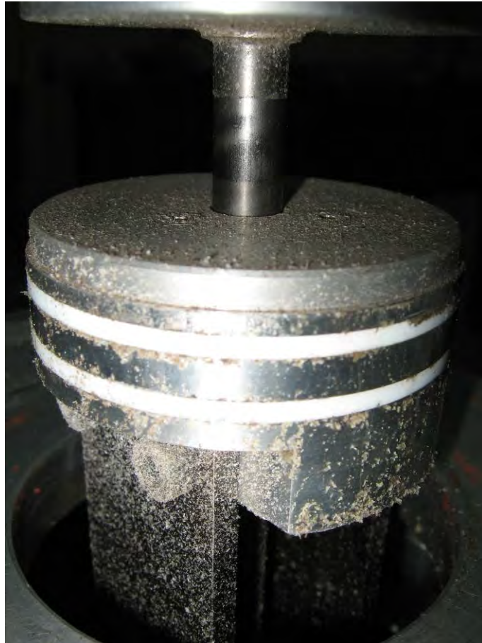
รูปที่ 5-18 การสึกหรอของแหวนลูกสูบกำลัง
