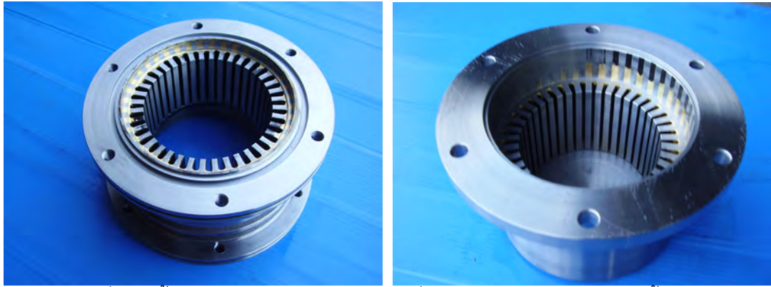
รูปที่ 4-2 ชิ้นส่วนของฮีตเตอร์และคูลเลอร์ที่ได้ออกแบบและผลิตไปในครั้งแรก
