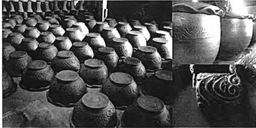
รูปที่ 3.90 การตกแต่งลวดลายบนผิวด้วยแม่พิมพ์ลูกกลิ้ง และการตากผลิตภัณฑ์ ของ โรงงานไซโซดินเผา อำเภอไชโย จังหวัดอ่างทอง
