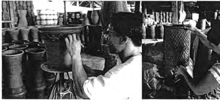
รูปที่ 3.95 การขึ้นรูปด้วยแป้นหมุนและการตกแต่งลวดลาย ของโรงงานเครื่องปั้นดินเผา ตำบลหูกวาง อำเภอบรรพตพิสัย จังหวัดนครสวรรค์
