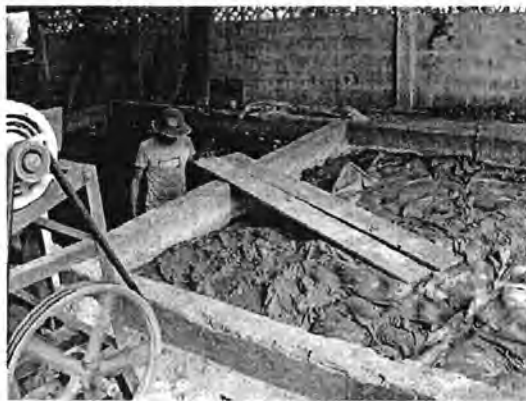
รูปที่ 3.70 บ่อหมักดิน ของโรงงานเครื่องปั้นดินเผา ตำบลศรีณรงค์ อำเภอไชโย จังหวัดอ่างทอง
