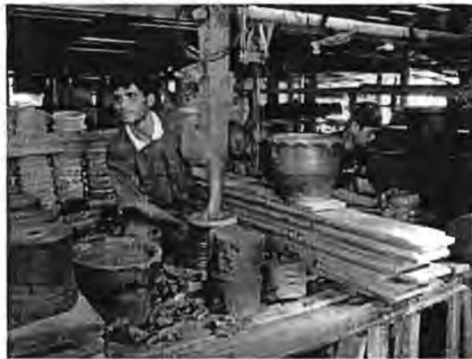
รูปที่ 3.89 การขึ้นรูปด้วยปั้นหมุน ของ โรงงานเครื่องปั้นดินเผา คำบลตรีณรงค์ อำเภอไชโย จังหวัดอ่างทอง
