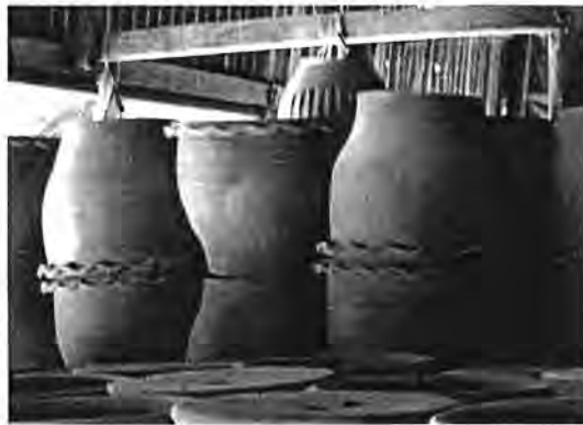
รูปที่ 3.82 รอยคราบขาวบนผลิตภัณฑ์ ของโรงงานเครื่องปั้นดินเผา ตำบลพระยาบันลือ อำเภอลาดบัวหลวง จังหวัดพระนครศรีอยุธยา
