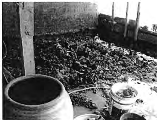
รูปที่ 3.74 บ่อหมักดิน ของโรงงานเครื่องปั้นดินเผา ตำบลหูกวาง อำเภอบรรพตพิสัย จังหวัดนครสวรรค์
