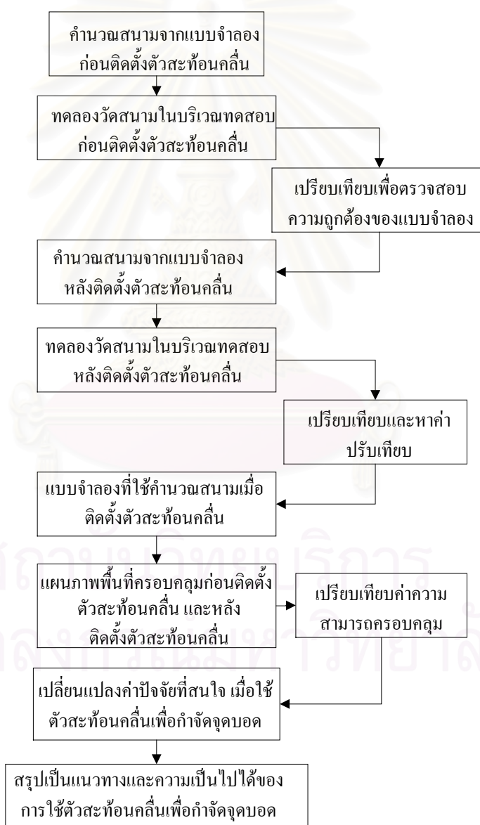
รูปที่ 3.2 ขั้นตอนการวิเคราะห์การกำจัดจุดบอดโดยใช้ตัวสะท้อนคลื่น
