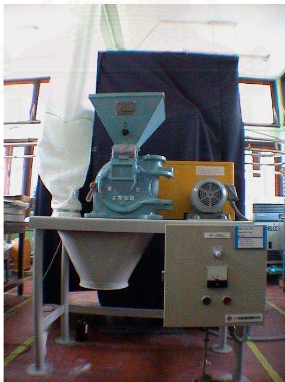
รูปที่ ก1 เครื่องบดแบบฟันขบ (Nara Jiyu Mill)
