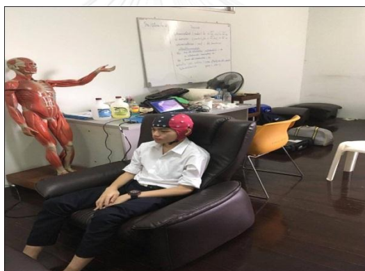
ภาพ ข. สวมหมวกวัดคลื่นสมองให้ผู้เข้าร่วมการวิจัยและฉีต Conductive Gel หรือน้ำยาสี้อสัญญาณไฟฟ้าเข้าที่ Electrode ตามจุดต่าง ๆ บนหมวก พร้อมทั้งเช็คความเสถียรของสัญญาณ
