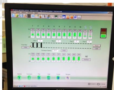
รูปที่ 3.6 เครื่องและโปรแกรมหลอมละลายตะกั่วให้ขาอุปกรณ์กับแผงวงจรเชื่อมติดกัน
