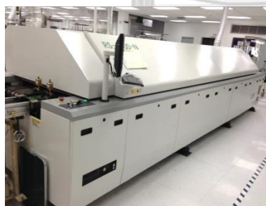
รูปที่ 3.6 เครื่องและโปรแกรมหลอมละลายตะกั่วให้ขาอุปกรณ์กับแผงวงจรเชื่อมติดกัน
