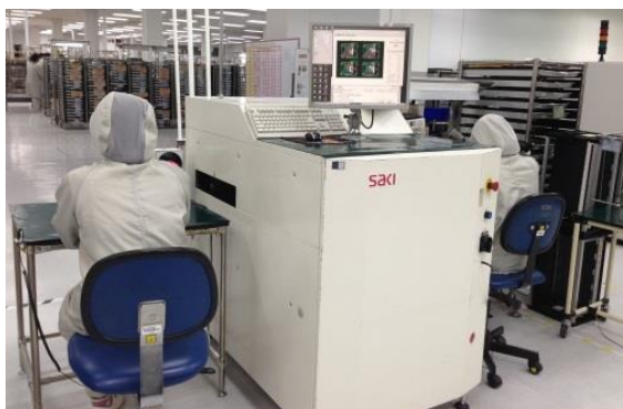
รูปที่ 3.7 เครื่องตรวจจับความผิดพลาดแผงวงจร
