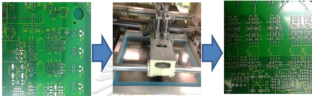
รูปที่ 3.3 แผ่นวงจรก่อนและหลังการพิมพ์ตะกั่วลงบนลายแผ่นวงจร
