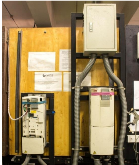
รูปที่ 4.5 เครื่องแปลงความถี่ไฟฟ้า (ABB™ model ACS401002032, ขนาด 50 Hz, ค่าความละเอียดเท่ากับ 0.1 Hz) (Soupramongkol, 2015)
