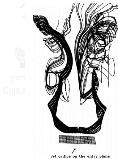
รูปที่ 2.4 การเกิดโครงสร้าง CVP จากการพัฒนาตัวของ vortex loop (Lim et al. , 2001)
