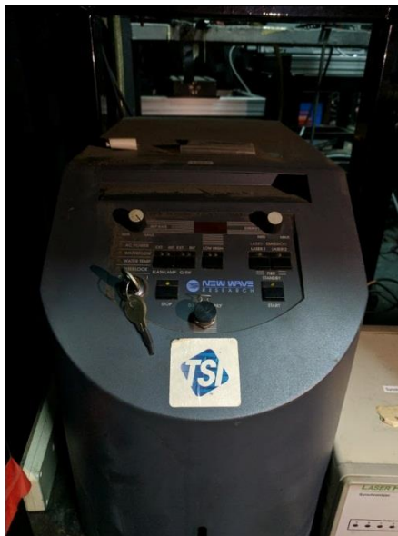
รูปที่ 4.10 เครื่องกำเนิดเลเซอร์ชนิด ND:YAG ยี่ห้อ New Wave Research™ (model Solo 200XT ซึ่งมีกำลังสูงสุด 200 mJ/pulse ที่ความยาวคลื่น 532 nm)
