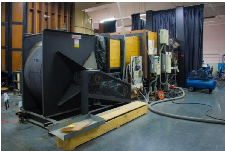
รูปที่ 4.3 อุโมงค์ลมภายในห้องปฏิบัติการวิจัยพลศาสตร์การไหลและการควบคุมการไหล ภาควิชาเครื่องกล คณะวิศวกรรมศาสตร์ จุฬาลงกรณ์มหาวิทยาลัย (Soupramongkol, 2015)
