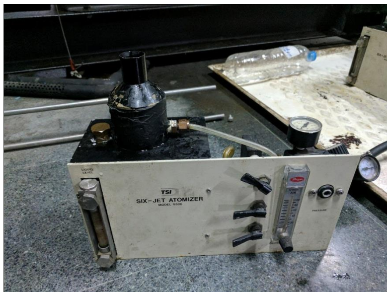
รูปที่ 4.12 เครื่องปล่อยอนุภาคติดตามการไหล TSI™ six-jet atomizer (TSI™ model 9306A)
