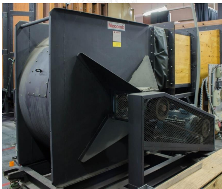
รูปที่ 4.4 พัดลมหอยโข่งแบบ backward curve airfoil blades (Soupramongkol, 2015)
