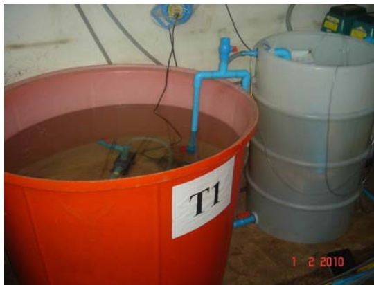
ภาพที่ 3.8 ระบบอนุบาลลูกปลาวัยอ่อนในโรงเรือนรอบที่ 2 ซึ่งประกอบด้วยถังอนุบาลและถังบำบัดไนตริฟิเคชัน
