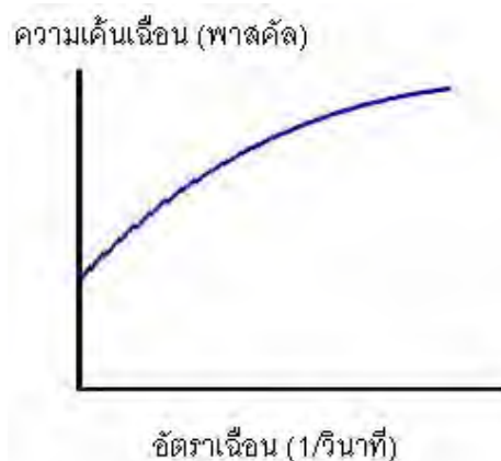
รูปที่ 2.5 กราฟความสัมพันธ์ระหว่างอัตราเฉือนและความเค้นเฉือนของของเหลวแสดงพฤติกรรมสภาพพลาสติก
