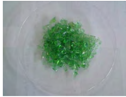
ภาพที่ ผ19 เศษแก้วสีเขียว (ขนาด 4 มิลลิเมตรจากโรงงาน)
