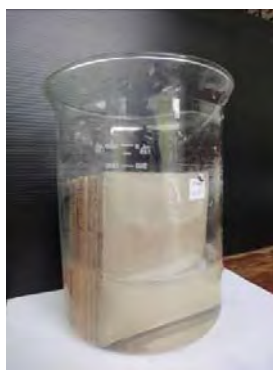
ภาพที่ 3.3 การแช่กระเบื้องในสารละลายกรด หรือสารละลายด่าง
