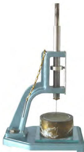
รูปที่ 3.6 อุปกรณ์ทดสอบเวลาในการเซ็ตตัวของปูน (Vicat apparatus)
