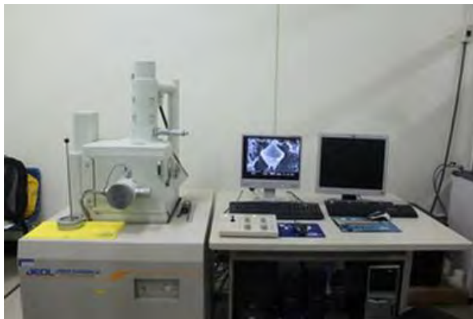
รูปที่ 3.11 กล้องจุลทรรศน์อิเล็กตรอนแบบส่องกราด (scanning electron microscope,SEM)
