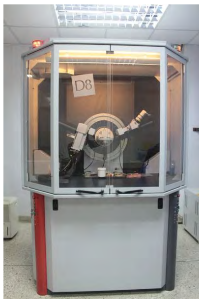
รูปที่ 3.10 เครื่อง X-ray diffractometer รุ่น D8-Advance ผลิตโดยบริษัท Bruker
