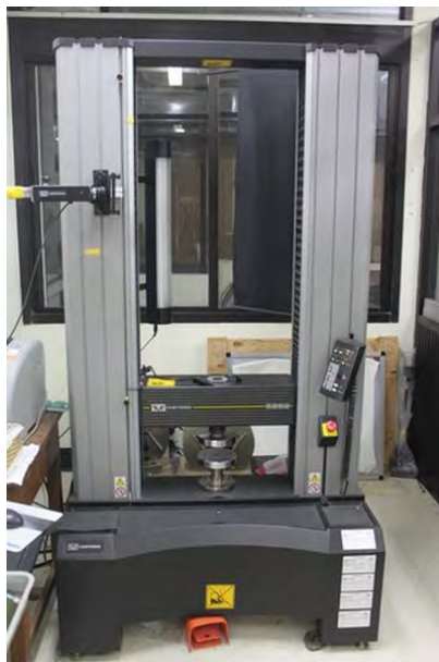
รูปที่ 3.9 เครื่อง Compressive strength รุ่น 5882 ผลิตโดยบริษัท INSTRON
