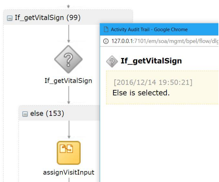
รูปที่ 2-5 การแสดงเส้นทางการทดสอบของเครื่องมือ โดยจะแสดงเฉพาะโหนดที่ถูกทดสอบ
