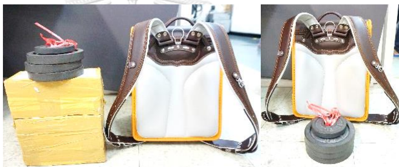
รูปที่ 3.8 ลักษณะการจัดเรียงสิ่งของเพื่อกำหนดตำแหน่งของจุดศูนย์กลางมวล
