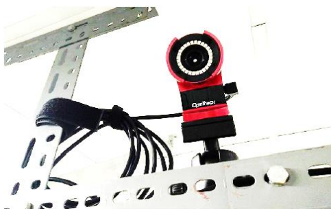
รูปที่ 3.2 กล้องอินฟาเรด รุ่น Flex 13
