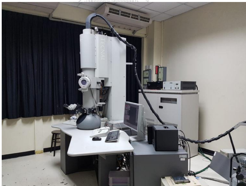
รูปที่ 3.12 เครื่อง Trans Electron Microscope บริษัท FEI TECNAI รุ่น T20 G 2
