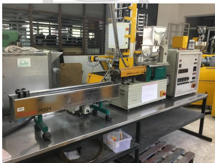
รูปที่ 3.6 เครื่องอัดรีดสกรูคู่ของ Thermo Prism รุ่น DSR-28
