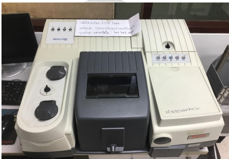
รูปที่ 3.22 เครื่องฟูเรียรทรานส์ฟอร์มอินฟราเรดสเปกโตรมิเตอร์ บริษัท Thermo Scientific รุ่น Nicolet 6700
