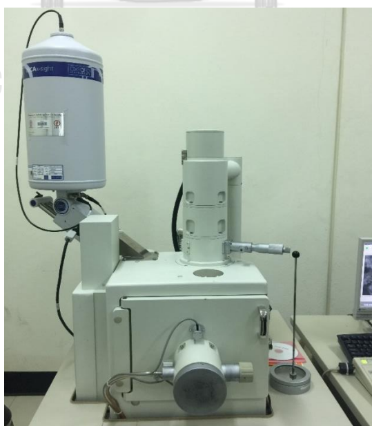
รูปที่ 3.13 เครื่อง Scanning Electron Microscope บริษัท JEOL รุ่น JSM-6400LV
