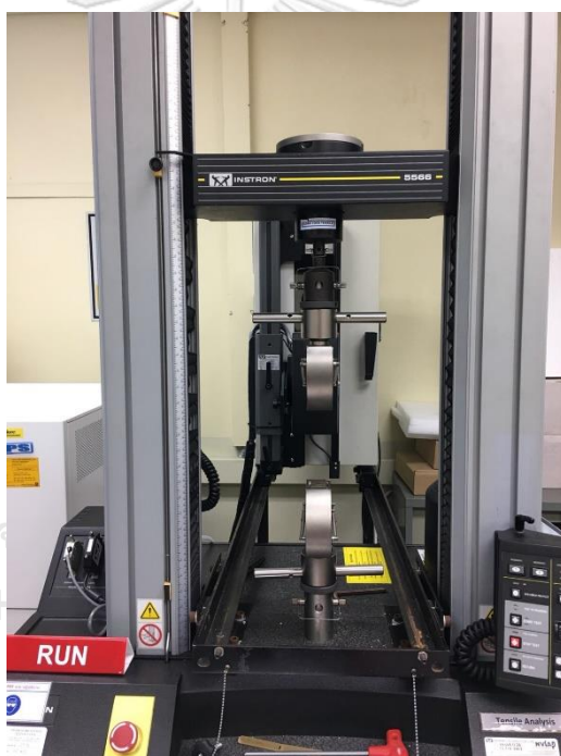
รูปที่ 3.14 เครื่องยูนิเวอร์แซล บริษัท Instron รุ่น 5566
