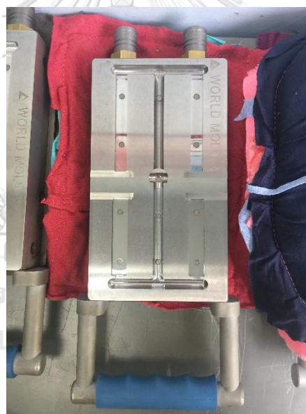
รูปที่ 3.9 แม่พิมพ์ที่ใช้ในการฉีดยื่นรูปชิ้นงานเพื่อทดสอบความทนแรงกระแทก
