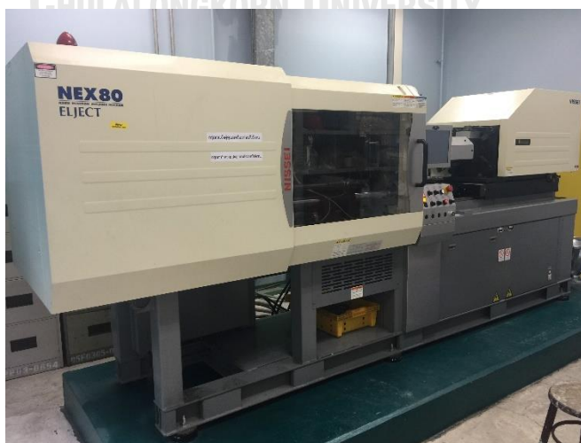
รูปที่ 3.7 เครื่องฉีดขึ้นรูปของบริษัท Nissei Injection Molding Machine รุ่น NEX80
