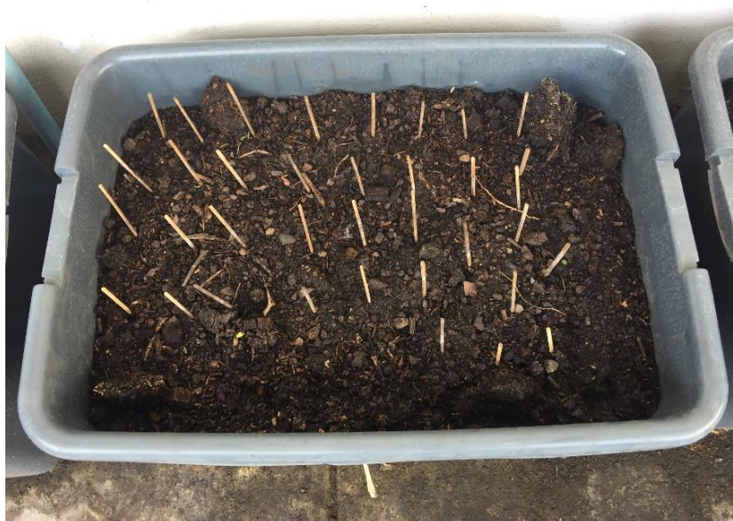
รูปที่ 3.20 กระบะพลาสติกที่ใช้ในการทดสอบการย่อยสลายด้วยวิธีการฝังกลบ
