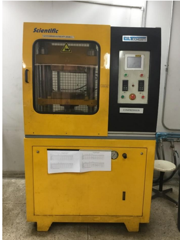
รูปที่ 3.10 เครื่องอัดขึ้นรูปด้วยความร้อนยี่ห้อ Labtech Engineering รุ่น LP20-b
