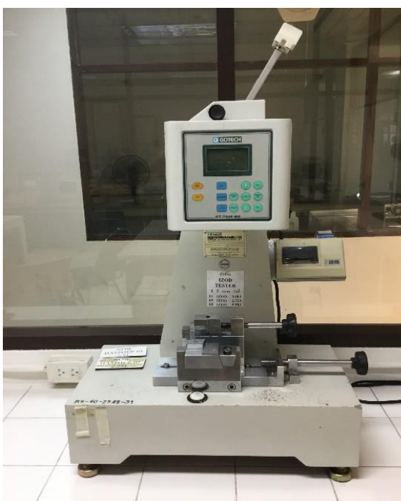
รูปที่ 3.18 เครื่องทดสอบแรงกระแทก บริษัท Gotech Testing Machine รุ่น GT-7045-MDH
