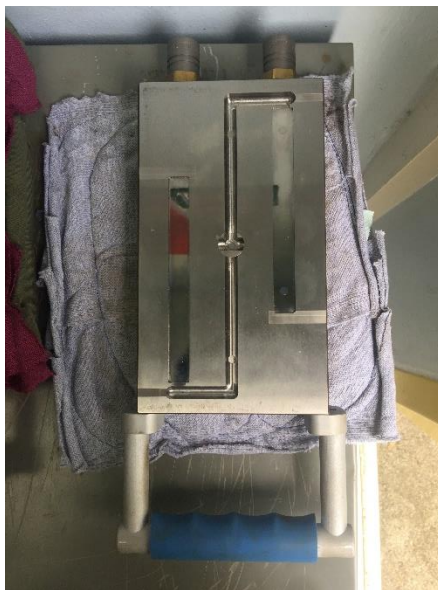
รูปที่ 3.8 แม่พิมพ์ที่ใช้ในการฉีดยื่นรูปชิ้นงานเพื่อทดสอบสมบัติเชิงกล
