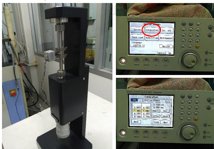
รูปที่ ก.4 การปรับระยะของคลิบเกจและกรอกข้อมูลให้ชุดควบคุมเพื่อสอบเทียบคลิบเกจ
