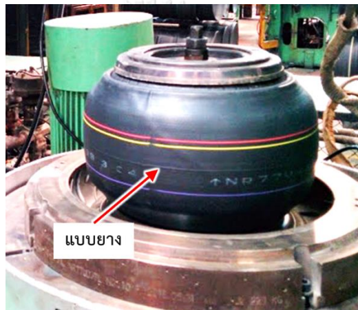
รูปที่ 4.14 แบบยางที่ถูกขึ้นรูปด้วยแรงดันไอน้ำ
