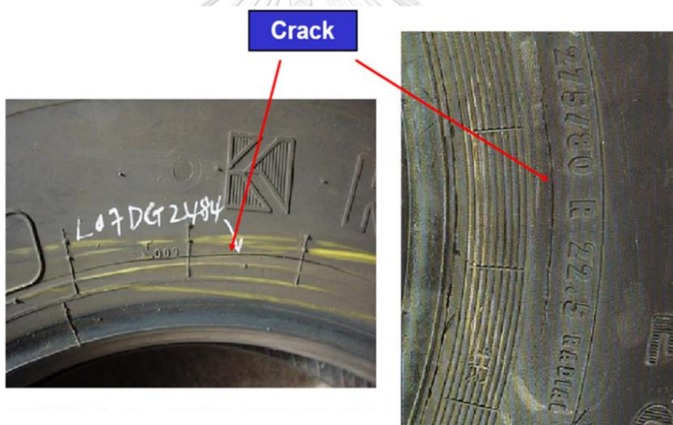
รูปที่ 2.12 แสดงลักษณะรอยแตกในชั้นเนื้อยางตามแนวเส้นรอบวง (ที่มา : บริษัท ยางคุมโฮ, Kumho Tire Co., Inc.)
