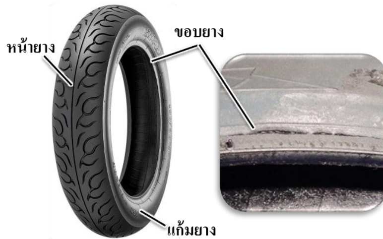
รูปที่ 2.2 หน้ายาง, ขอบยาง และปัญหารอยแตกบริเวณขอบยาง
