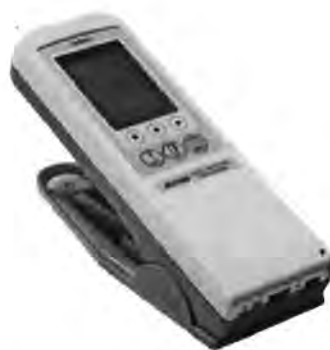
ภาพที่ 15: ตัวอย่างเครื่องวัดความดำ IHARA R730 Color reflection densitometer (37)
