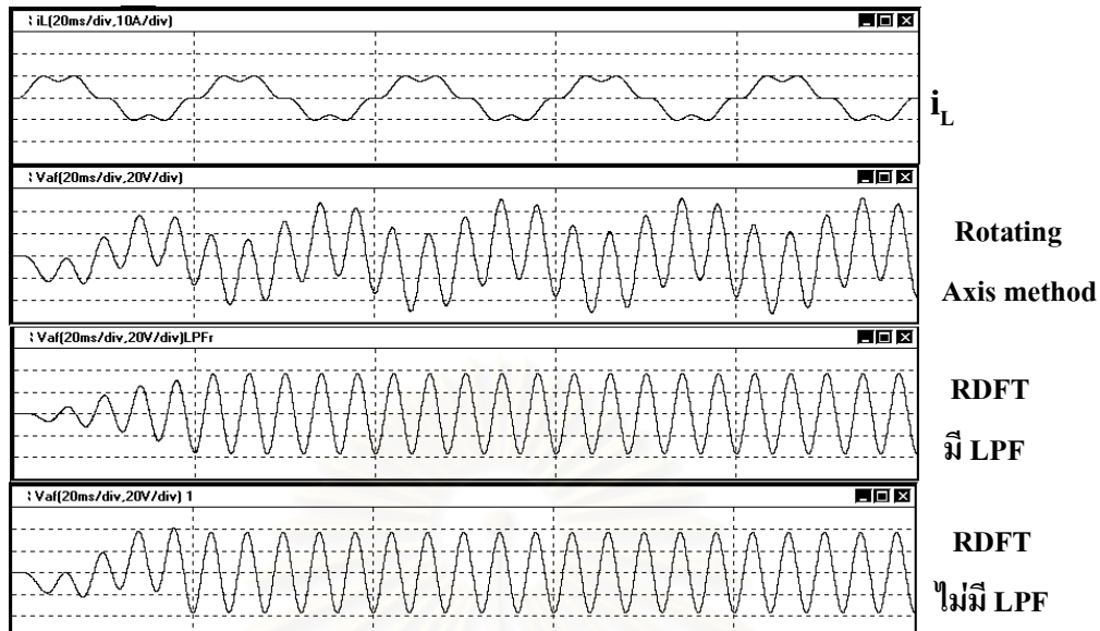
รูปที่ 3.10 ช่วงเวลาตอบสนองในการตรวจจับกระแสฮาร์มอนิกที่แปลงเป็นแรงดันของวงจรถองแอกทีฟด้วยวิธีต่างๆ
