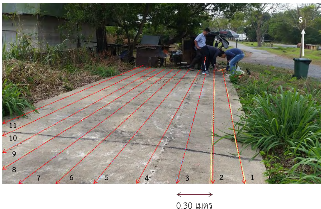
รูปที่ 3.10 แนวการสำรวจและทิศทางการลากของสายอากาศความถี่ 400 เมกะเฮิรตซ์
