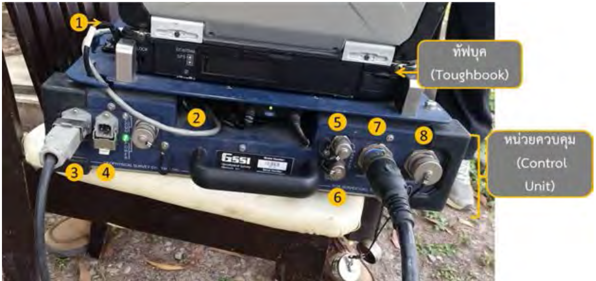
รูปที่ 3.4 ตำแหน่งจุดเชื่อมต่อ 9 จุดบนหน่วยควบคุม
