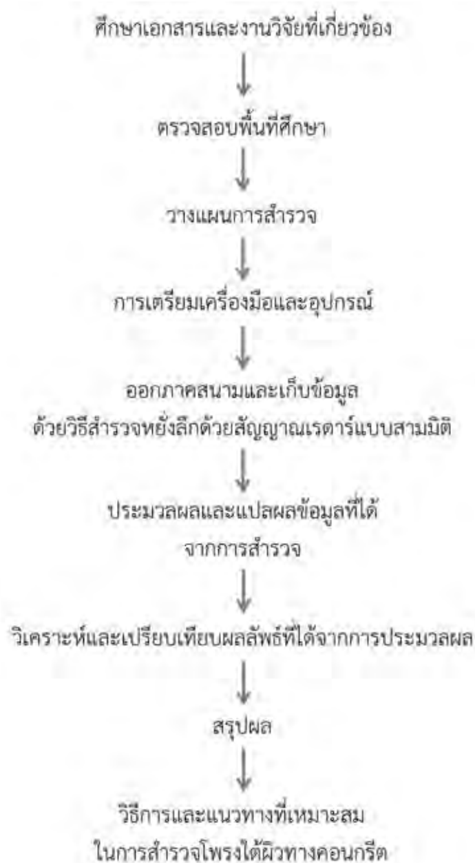
รูปที่ 3.1 ขั้นตอนการดำเนินงานทั้งหมดในการสำรวจแบบจำลองโพรงใต้ผิวดินทางคอนกรีตด้วยวิธีสำรวจหยั่งลึกด้วยสัญญาณเรดาร์แบบสามมิติ
