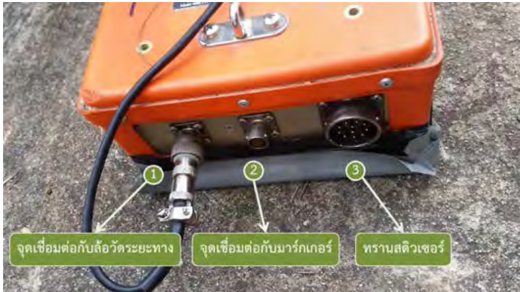
รูปที่ 3.8 ตำแหน่งจุดเชื่อมต่อ 3 จุดบนสายอากาศความถี่ 900 เมกะเฮิรตซ์
