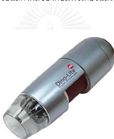
รูปที่ ก.5 แสดงกล้องอัตราขยายสูง dino lite plus
