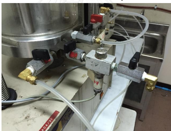
รูปที่ 3.8 Pore pressure transducer ใช้ในการเก็บค่าความดันที่เกิดขึ้น
