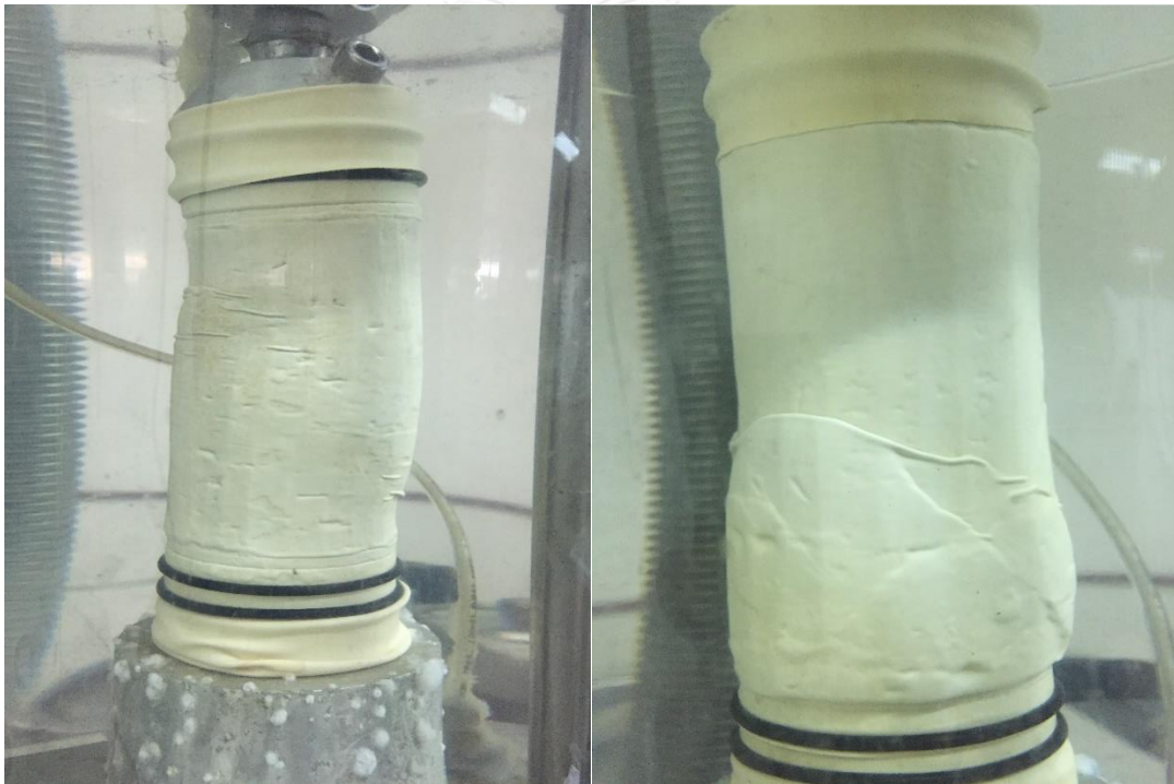
รูปที่ 3.21 ตัวอย่างการวิบัติของดินตัวอย่างทดสอบ
