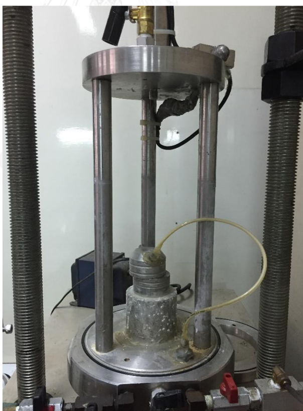
รูปที่ 3.1 เครื่องมือทดสอบแรงอัดสามแกนแบบเสายู่ข้างใน
