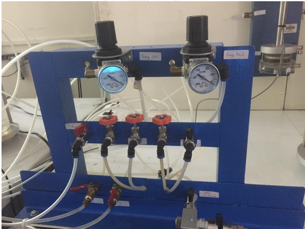
รูปที่ 3.19 ตัวอ่านค่าความดันและวาล์วแบบหมุน
