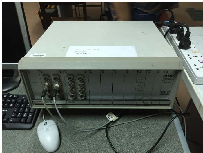
รูปที่ 3.7 Data logger สำหรับเก็บข้อมูลและประมวลผล
