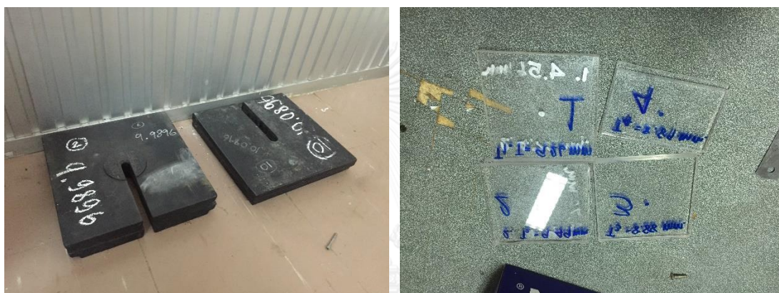
รูปที่ 3.9 ก แผ่นเหล็กที่ทราบน้ำหนัก ข แผ่นอะคริลิกที่ทราบความหนา
