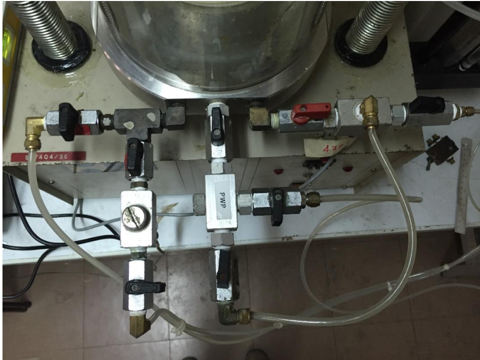
รูปที่ 3.17 การติดตั้งอุปกรณ์ตรวจวัดความชื้นและวาล์วเปิด-ปิด
