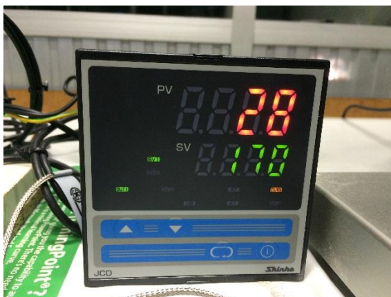
รูปที่ 3.9 ค่าอุณหภูมิของเครื่องหลอมจากเครื่องควบคุมอุณหภูมิ
