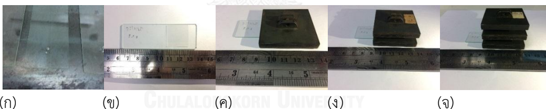
รูปที่ 3.10 (ก) สารเคมีบนเครื่องหลอมได้รับความร้อนจนถึงจุดหลอมเหลว
