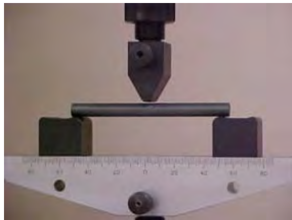
รูปที่ 2.15 การทดสอบการโค้งงอโดยวิธีใส่แรงกระทำ 3 จุด ( www.testdandproven.com )
