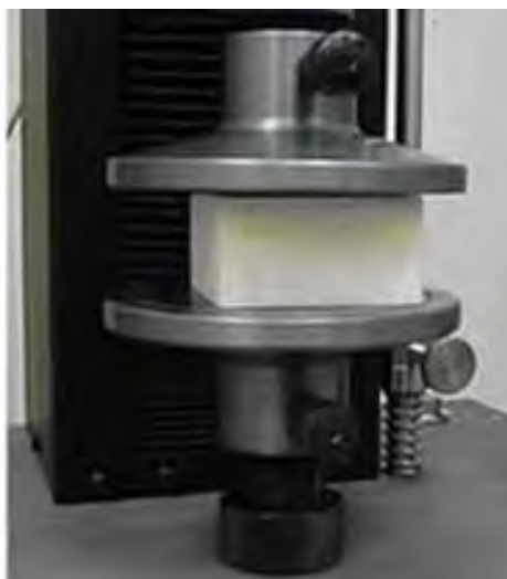
รูปที่ 2.14 การทดสอบการต้านทานแรงกด (www.testdandproven.com)
