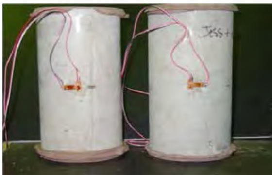
ภาพที่3.9 การทดสอบหาค่าโมดูลัสยืดหยุ่นและอัตราส่วนโพซงของคอนกรีตสมรรถนะสูงมาก
