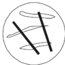
ภาพที่ 2.17 แสดงรอยร้าวจากการใช้เส้นใยต่างขนาดกัน (Marko และคณะ, 2004)
