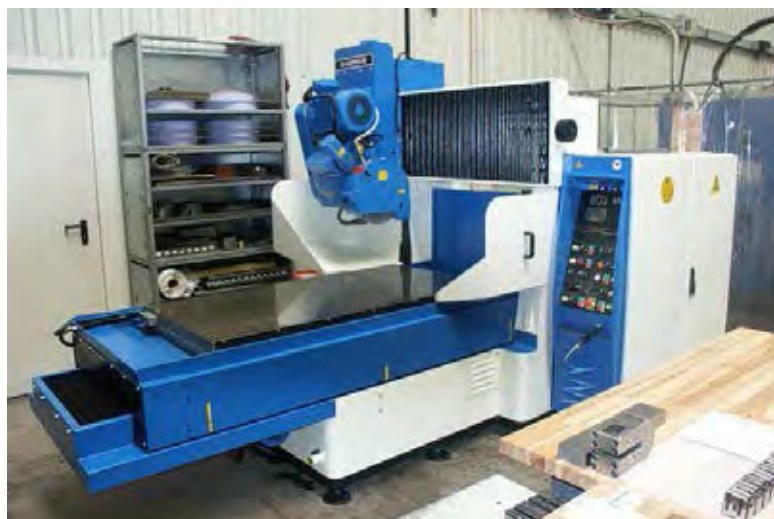
ภาพที่ 2.8 ตัวอย่างเครื่องเจียรแบบซีเอ็นซี
