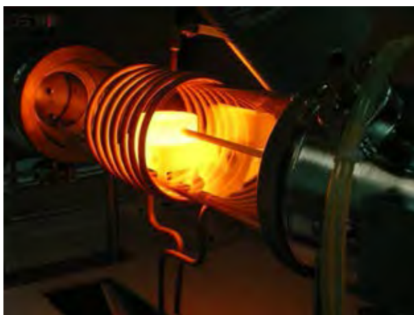
ภาพที่ 2.5 ตัวอย่างเครื่องจักรชุบผิวแข็งแบบเหนี่ยวนำ
