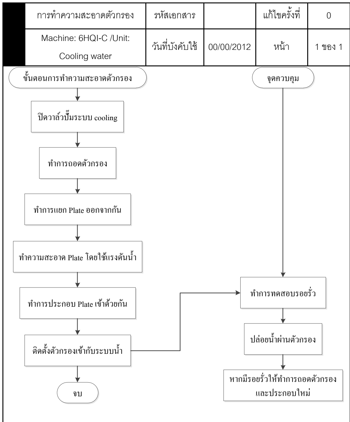
ภาพที่ 5.8 เอกสารประกอบการซ่อมบำรุงของปัญหา ALARM COOLING WATER
