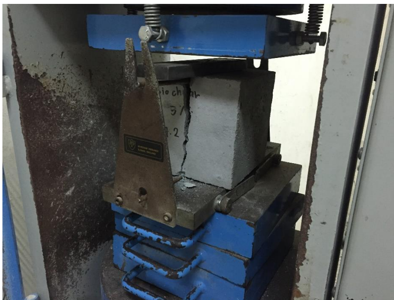
รูปที่ 3.13 การทดสอบกำลังดึง Splitting Tensile Strength
