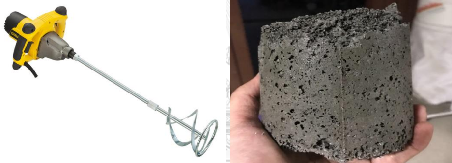
รูปที่ 3.2 คอนกรีต CLC ที่เกิดการแตกตัวของโฟมและยุบตัวผสมด้วย mixer แบบทั่วไป
