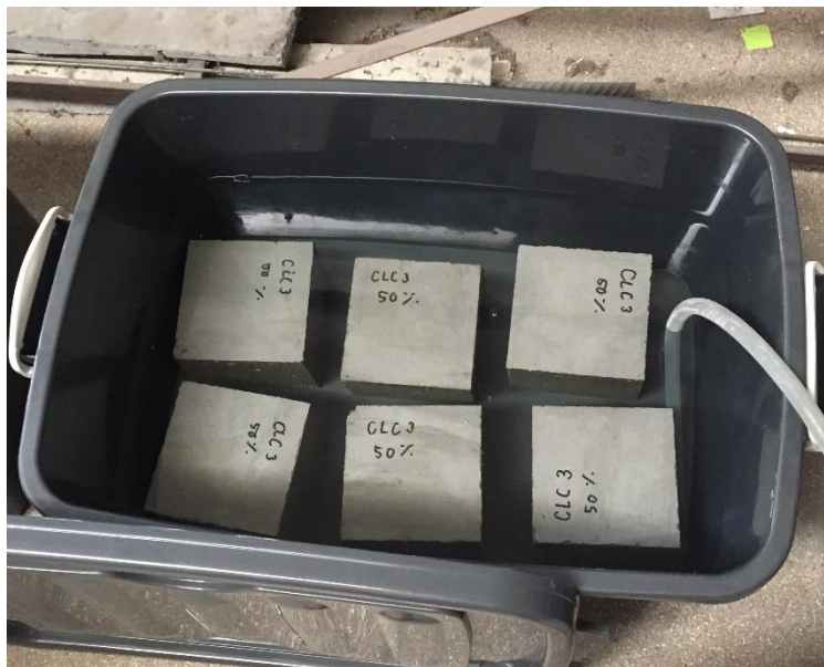
รูปที่ 3.12 การบ่มคอนกรีตในน้ำเพื่อใช้เป็นมวลของตัวอย่างทดสอบในสภาพเปียก
