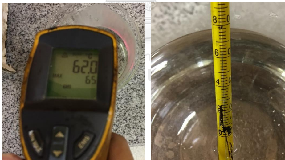
รูปที่ 4.19 การทดสอบความคลาดเคลื่อนที่เกิดจากเครื่องมือ
