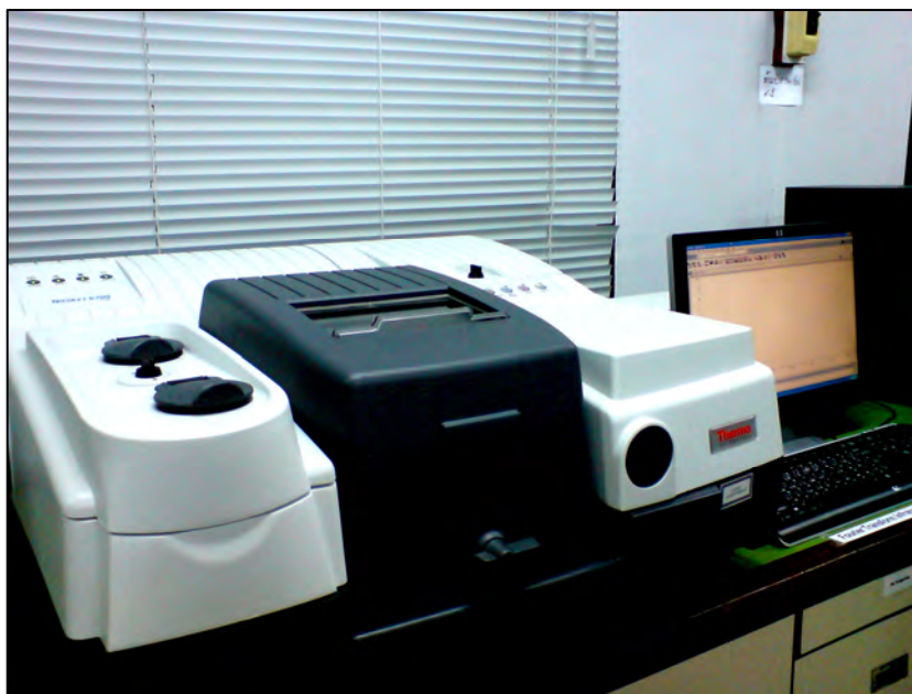
รูปที่ 3.6 เครื่อง Fourier Transform Infrared Spectrophotometer (FT-IR) รุ่น Nicolet 6700
