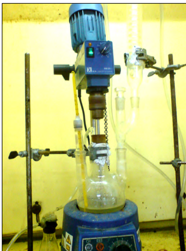
รูปที่ 3.4 อุปกรณ์การสังเคราะห์พอลิยูรีเทนด้วยเทคนิคการสังเคราะห์พอลิเมอร์แบบสารละลาย
