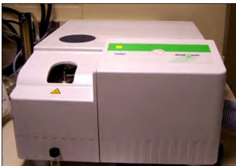
รูปที่ 3.9 เครื่อง Differential Scanning Calorimeter (DSC) รุ่น METTLER TOLEDO DSC822 ๑
