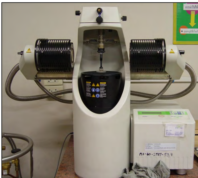
รูปที่ 3.10 เครื่อง Dynamic Mechanical Analyzer (DMA) รุ่น METTLER TOLEDO DMA/SDTA861°
