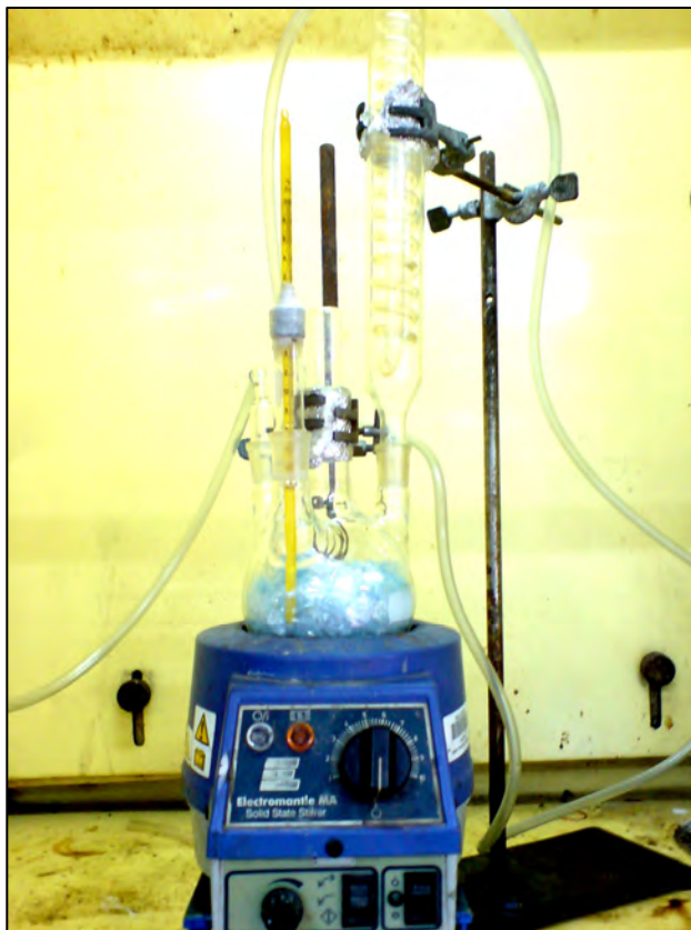
รูปที่ 3.2 อุปกรณ์การย่อยสลายขวดเพ็ดด้วยการไกลโคไลซิส
