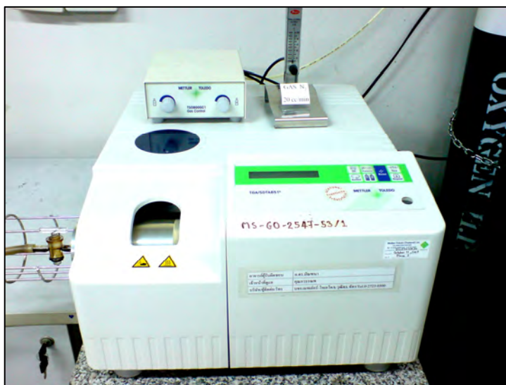
รูปที่ 3.8 เครื่อง Thermogravimetric Analyzer (TGA) รุ่น METTLER TOLEDO TGA/SDTA851 ๑
