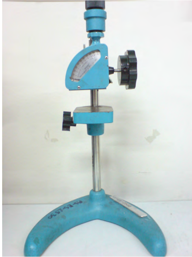
รูปที่ 3.11 เครื่องดูโรมิเตอร์ (durometer) ชนิดชอร์ เอ (shore A)
