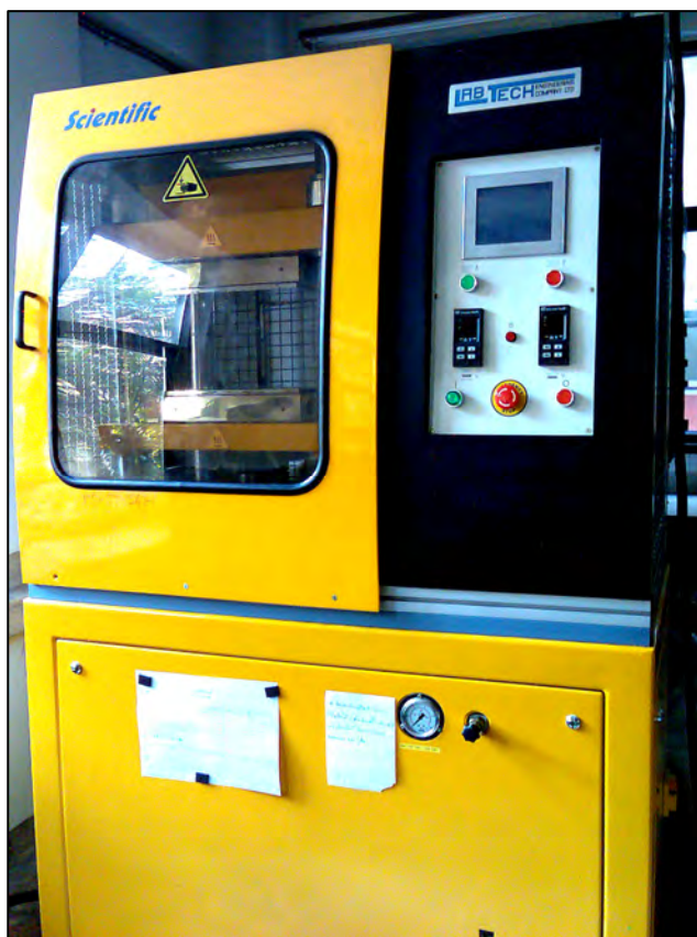
รูปที่ 3.5 เครื่องอัดแบบ (compression molding) รุ่น Scientific
