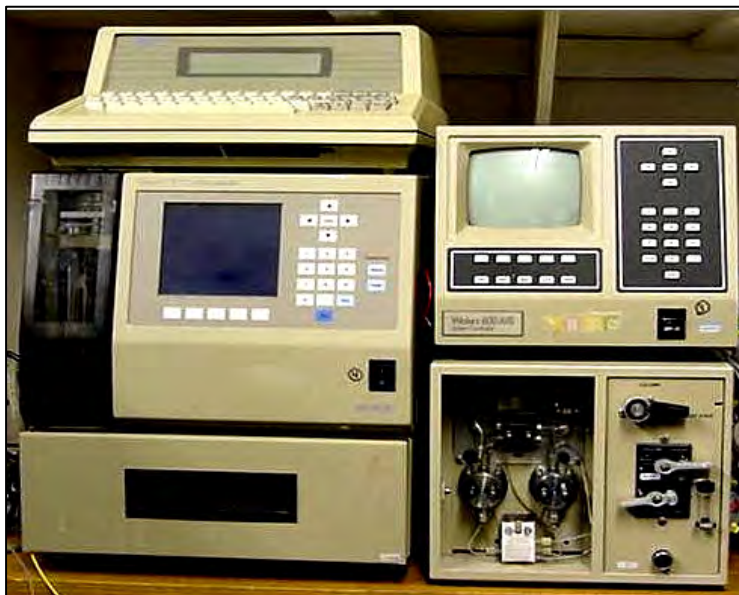
รูปที่ 3.7 เครื่อง Gel Permeation Chromatography (GPC) รุ่น Waters 600
