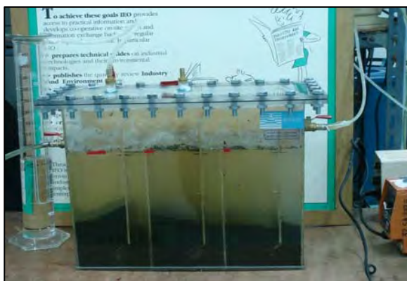
รูปที่ 3.6 การติดตั้งชุดถังปฏิกริยา (A) และชุดถังปฏิกริยา (B)
