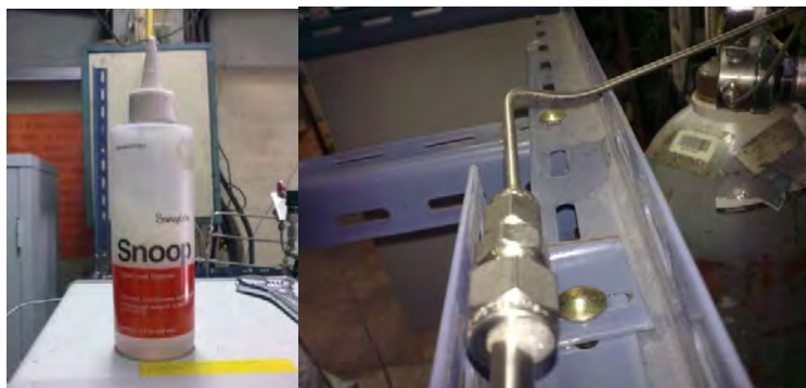
รูปที่ 4.2 แสดงการทดสอบการรั่วของแก๊สในระบบ
