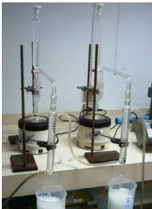
รูปที่ 3-2 การต่อชุดอุปกรณ์การกลั่นสกัด (TAPPI T223 cm-01)
