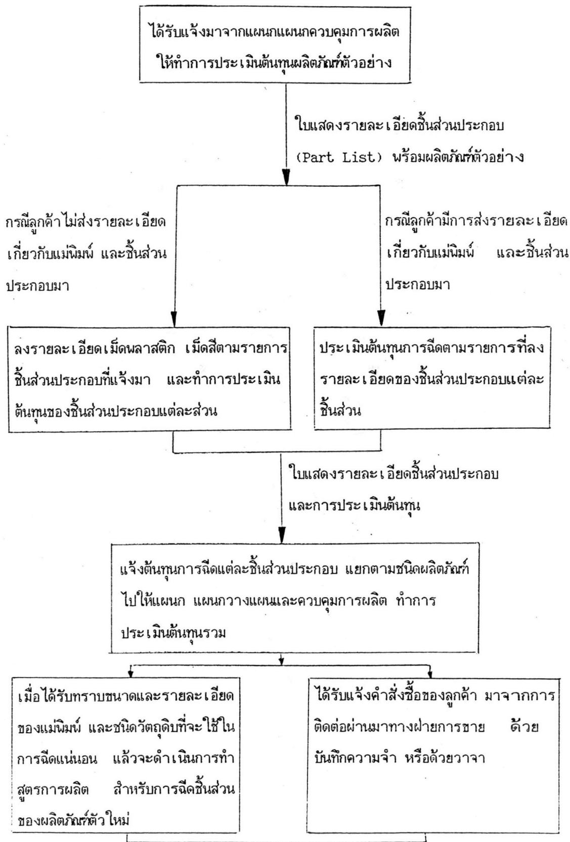
รูปที่ 5.17 แสดงการไหลของกิจกรรมการทำงานของแผนกการจีด (ก่อนการปรับปรุง)
