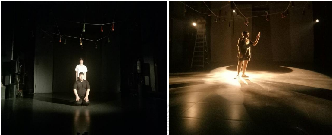
ภาพที่ 4.40 ภาพตัวอย่างการจัดตำแหน่งไฟบริเวณด้านข้าง (Side Light) ทั้งทางด้านขวาและด้านซ้ายของเวที (ภาพขวา) และแสงที่มาจากด้านหลังของเวที (Back Light) (ภาพซ้าย)
