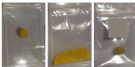
รูปที่ 3.4 วัสดุตรวจวัดเอทานอลห่อหุ้มด้วยพลาสติก
