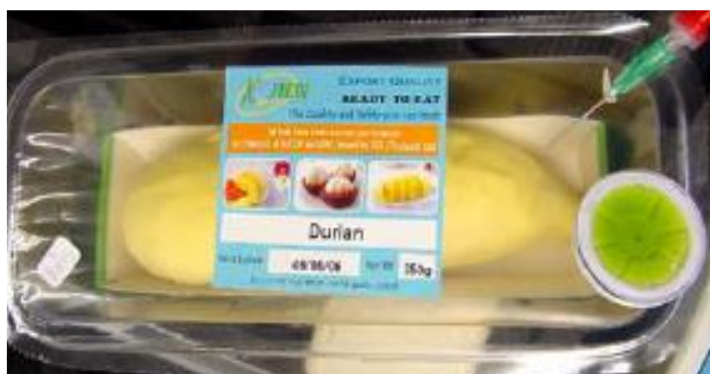
รูปที่ 2.15 ระบบตรวจวัดคาร์บอนไดออกไซด์ วรภัทรและอรรณฤทธิ์ (2549)
