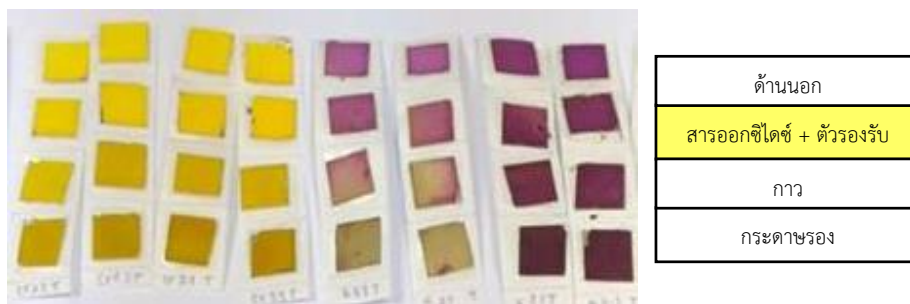
รูปที่ 3.2 สารออกซิไดซ์โปแทสเซียมไดโครเมตและโปแทสเซียมเปอร์แมงกาเนตบนวัสดุรองรับแผ่นซิลิกาเจล
