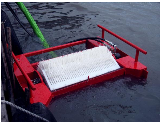
รูปที่ 2-8 สกิมเมอร์แบบแปรง (Brush skimmer)
