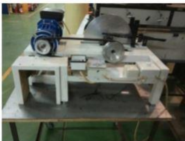
รูปที่ 2-31 อุปกรณ์สกิมเมอร์แบบดิสก์ที่ใช้ในงานวิจัย (Widiaksana, Yudiana และ Nugroho, 2018)
