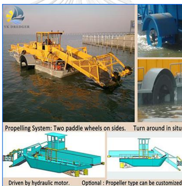
รูปที่ 2-9 สกิมเมอร์แบบใบพัด (Paddle skimmer)
