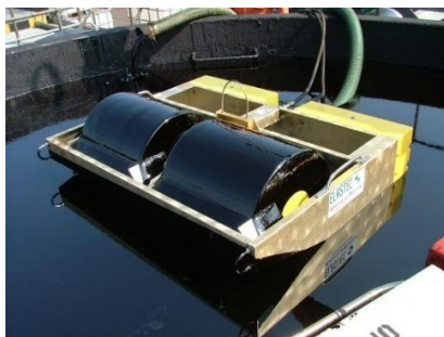
รูปที่ 2-3 สกิมเมอร์แบบลูกกลิ้ง (Drum skimmer)
