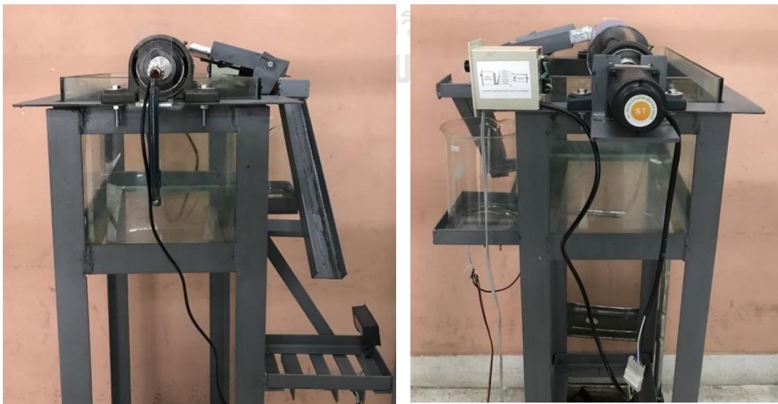
รูปที่ 3-14 การติดตั้งอุปกรณ์สกิมเมอร์แบบลูกกลิ้ง (ด้านข้าง)
