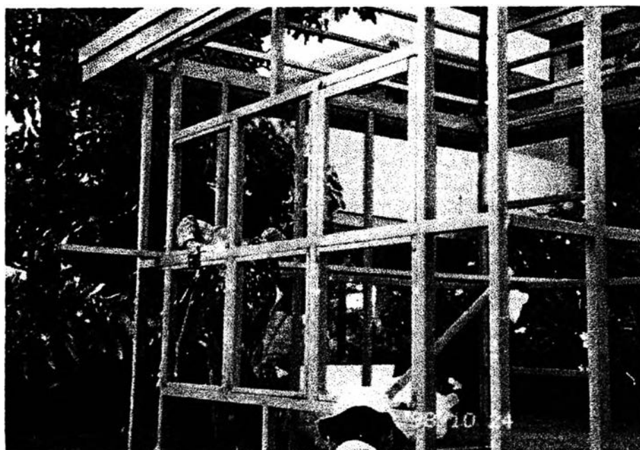
ภาพที่ 3.6 ภาพแสดงโครงสร้างช่องที่เตรียมไว้ติดตั้งผนังทดสอบ
