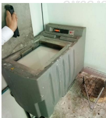
รูปที่ 4-59 ขั้นตอนการละลายตัว support ออก
