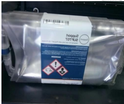
รูปที่ 4-57 ตัวอย่างเรซินที่ใช้กับเครื่องพิมพ์ ชนิด PolyJet
