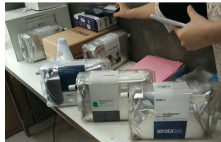
รูปที่ 4-11 เรซินที่ใช้สำหรับพิมพ์ชิ้นงาน
