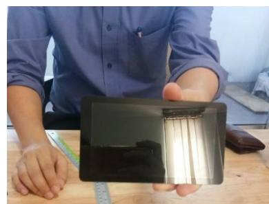
รูปที่ 4-38 ตัวอย่างระบบฉายแสงของเครื่องพิมพ์ชนิด DLP
