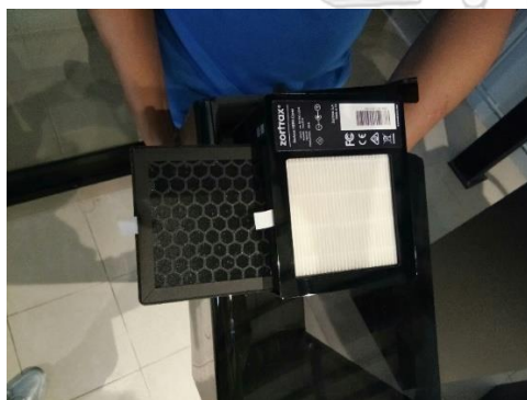
รูปที่ 4-46 ชุดกรองอากาศของเครื่องพิมพ์ FDM
