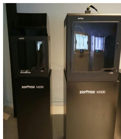
รูปที่ 4-45 เครื่องพิมพ์ FDM ยี่ห้อ Zortrax
