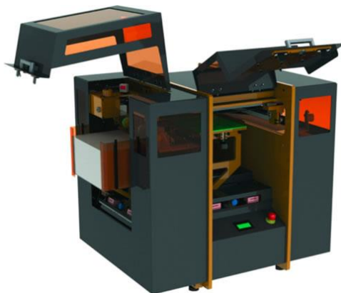
รูปที่ 2-8 เครื่องพิมพ์ 3 มิติ ชนิด selective deposition lamination (SDL)
