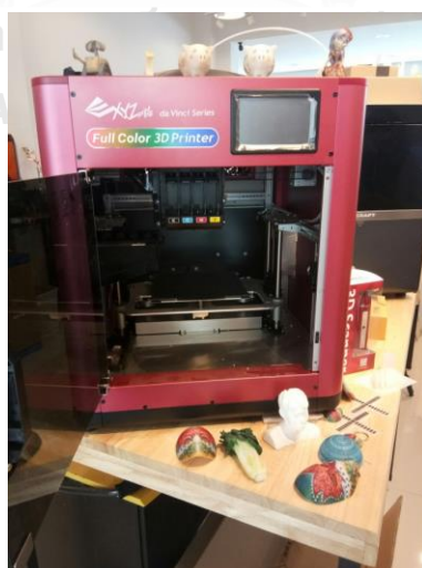
รูปที่ 4-29 เครื่องพิมพ์ FDM มัลติคัลเลอร์
