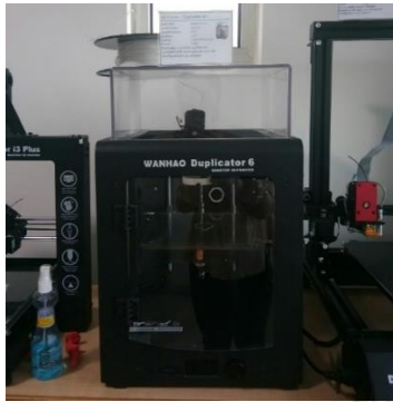
รูปที่ 4-33 เครื่องพิมพ์ชนิด FDM มีกระจกปิดกันฝุ่น
