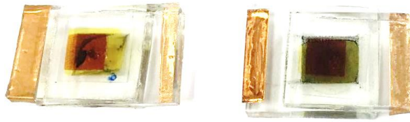
รูปที่ 4.6 เซลล์สุริยะชนิดสีย้อมไวแสงที่ใช้ขั้วไฟฟ้าร่วมเป็นโลหะแพลททินัม (ซ้าย) และสารนิกเกิลเฮลเลไนต์ (ขวา)
