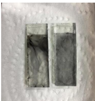
รูปที่ 4.5 ลักษณะของชั้นไฟฟ้าร่วมที่เคลือบด้วยโลหะแพลททินัม (ซ้าย) และสารนิกเกิลเซลไนด์ (ขวา)
