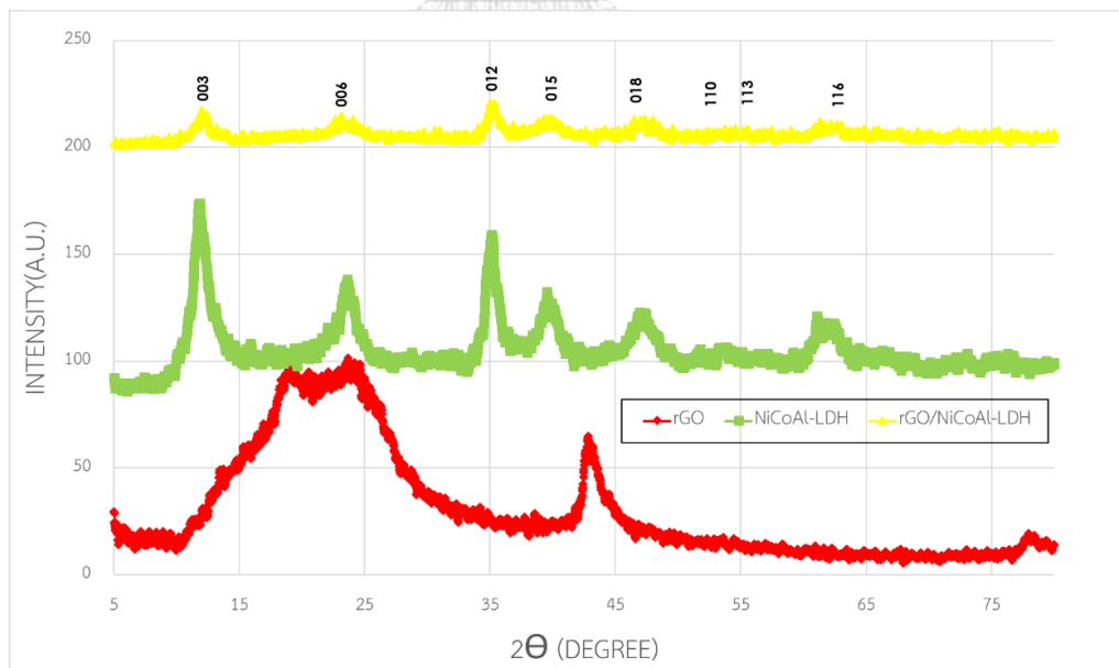
รูป 4.9 การเปรียบเทียบสเปกตรัมการเลี้ยวเบนด้วยรังสีเอ็กซ์ของรีดิวซ์กราฟีนออกไซด์, นิกเกิล โคบอลต์ อะลูมิเนียม เลเยอร์ดับเบิลไฮดรอกไซด์ และรีดิวซ์กราฟีนออกไซด์/นิกเกิล โคบอลต์ อะลูมิเนียม เลเยอร์ดับเบิลไฮดรอกไซด์
