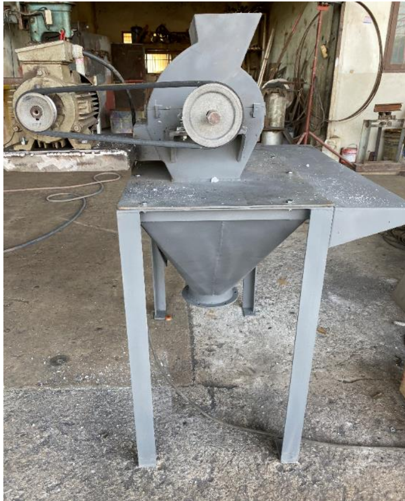
จพาลงกรณ์มหาวิทยาลัย Figure 49: Completed prototype of rock sugar chopping machine CHULALONGKORN UNIVERSITY
