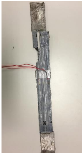
ภาพตัวอย่างการฉีกขาดของแผ่น CFRP
