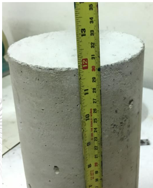
ตัวอย่างการวัดขนาดของคอนกรีตทรงกระบอกที่ใช้ทดสอบ
