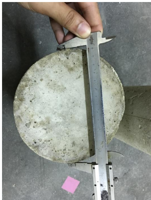
ตัวอย่างการวัดขนาดของคอนกรีตทรงกระบอกที่ใช้ทดสอบ
