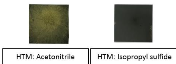
รูปที่ 39 การกระจายตัวของอนุภาคคอปเปอร์ซิงค์ทินซัลไฟด์บนชั้นเพอร์รอฟสไกต์ และการเสื่อมสภาพของเพอร์รอฟสไกต์ที่เกิดขึ้นจากการใช้ตัวทำละลายที่แตกต่างกัน
