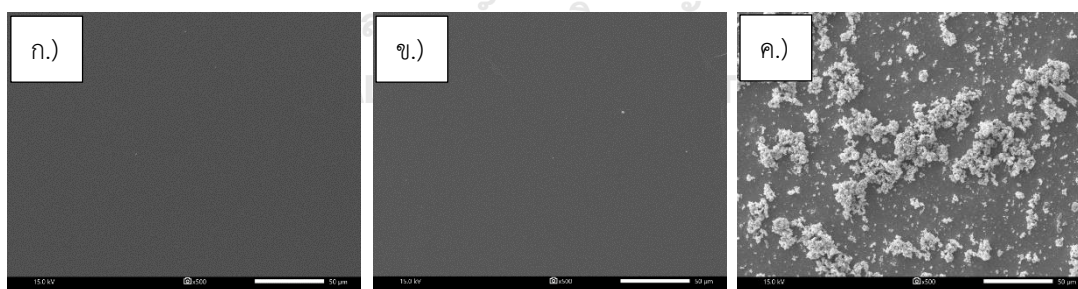
รูปที่ 41 บริเวณพื้นผิวการจัดเรียงตัวของอนุภาคด้วยเทคนิค SEM ที่กำลังขยาย 500 เท่า ก.) เพอร์รอฟสไกท์ ข.) spiro-OMeTAD ค.) อนุภาคคอปเปอร์ซิงค์ทินซัลไฟด์
