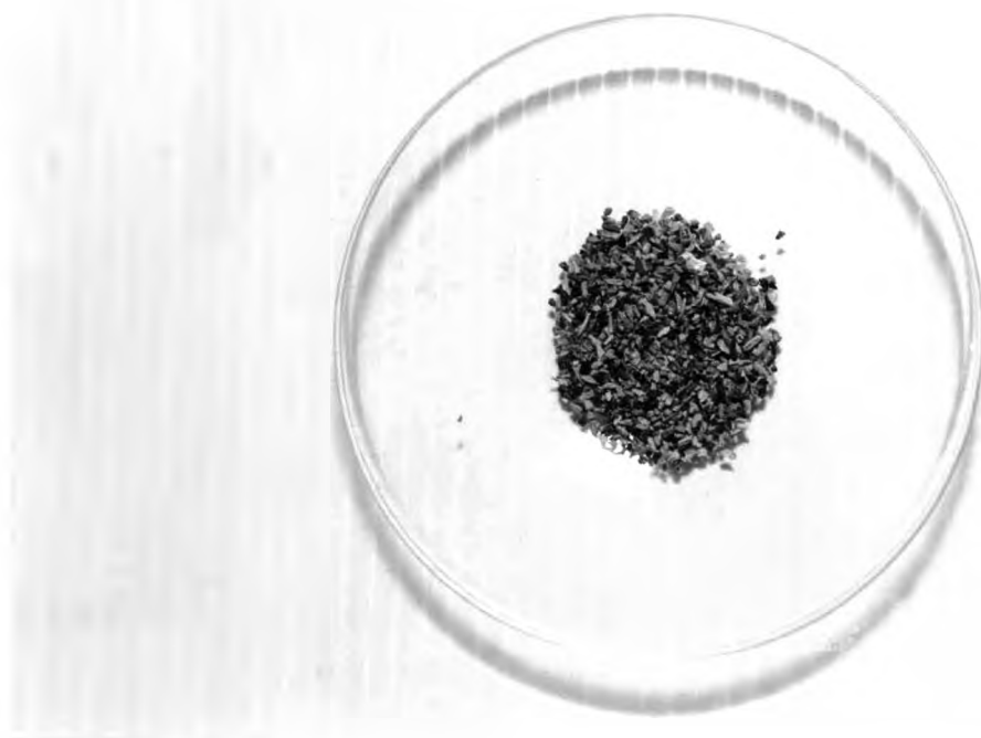
รูปที่ 4.2 กระดาษกรองที่เตรียมโดยเผาที่อุณหภูมิ 500 องศาเซลเซียส
