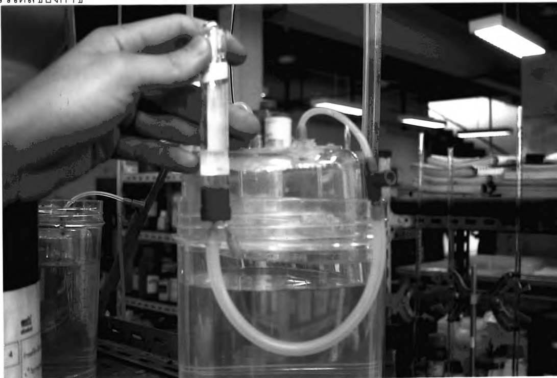
รูปที่ 4.9 ลักษณะการเก็บตัวอย่างก๊าซเพื่อส่งวิเคราะห์
