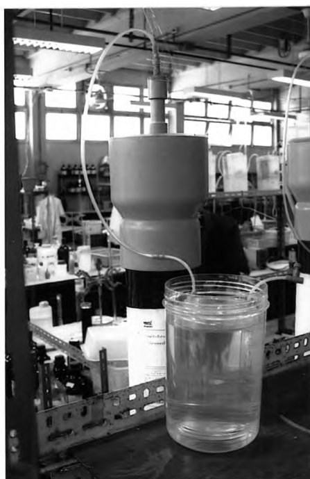
รูปที่ 4.7 เส้นทางของไหลของก๊าซเข้าสู่อุปกรณ์เก็บก๊าซ
