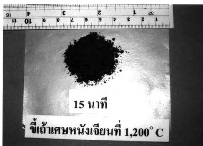
รูปที่ ข.3 ซีเถ้าจากการเผาเศษหนังเจียนที่อุณหภูมิ 400 800 และ 1,200 องศาเซลเซียส
