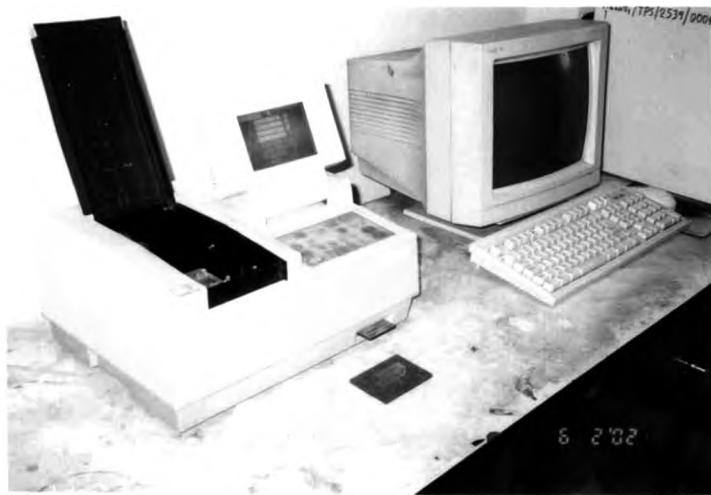
รูปที่ ข.9 เครื่อง Spectrophotometer สำหรับวัดโครเมียม
