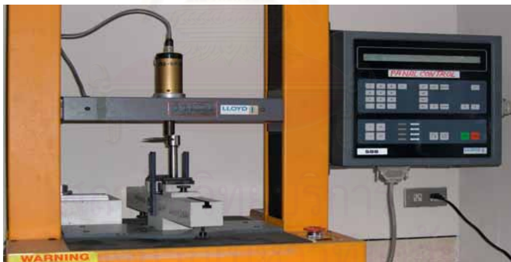
รูปที่ 3.7 แรงเค้นในชิ้นทดสอบขณะทดสอบความทนต่อแรงดัดโค้ง
