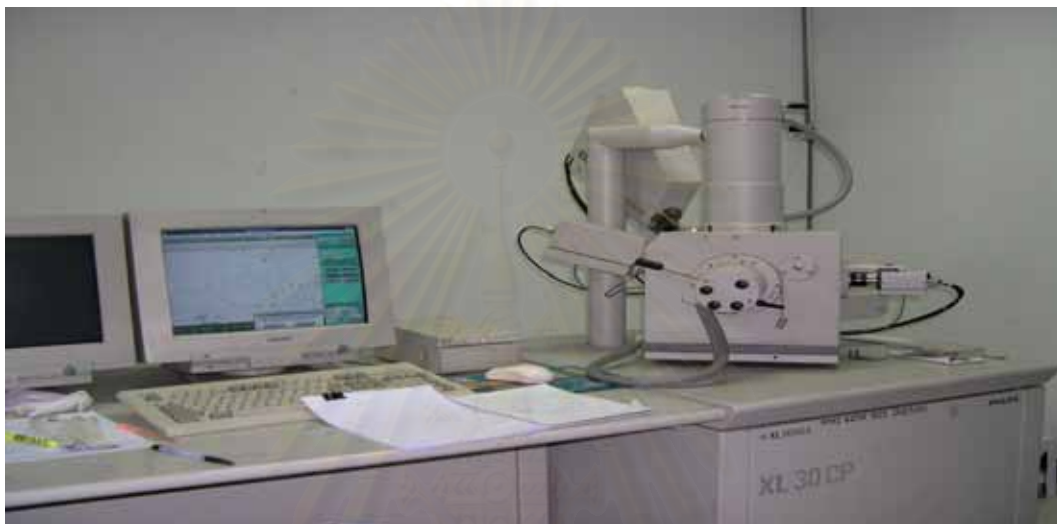
รูปที่3.3 Scanning Electron Microscope (SEM) รุ่นPhilips XL 30CP
