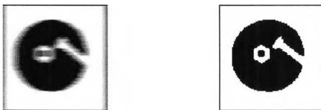
รูปที่ 2.24 แสดงรูปแบบการปรับผลจากการบิดเบี้ยวของภาพจากการเคลื่อนที่ของสายพาน
