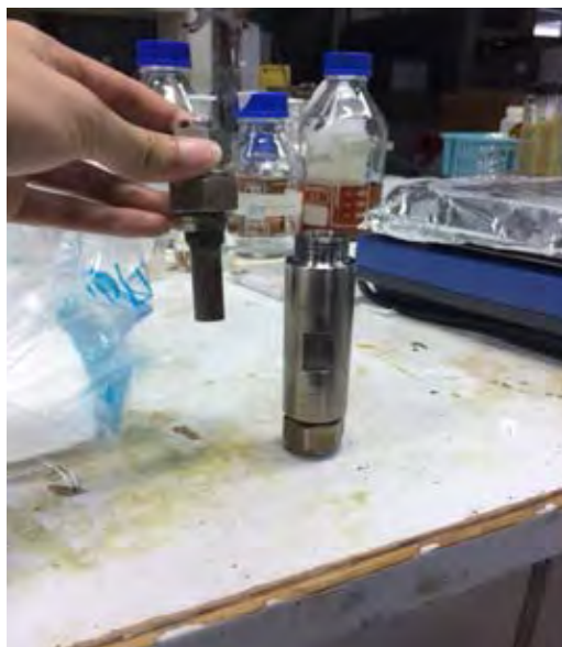
รูปที่ 1 ง. 8.8-ml stainless steel (SUS-316) batch reactor (AKICO Co., Japan)
